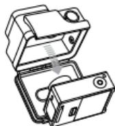
2. 移除相机的侧盖，然后将 **microSD**、**microSDHC™** 或 **microSDXC™** 卡插入到插卡槽。需要速度等级达到 Class 10 的 microSD 卡。
