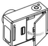
4. 为电池充电。随附的锂离子电池尚有余电。要为电池充电，请将随附的 USB 数据线连接到相机，再将数据线的另一端连接到诸如计算机、GoPro 插壁式充电器或 GoPro 自动充电器等电源设备。在充满电之前使用，不会对相机或电池造成任何损害。
