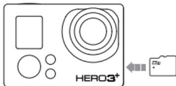
1. 将记忆卡滑入卡槽，标签朝向相机正面。
