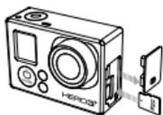
3. Ouvrez la porte arrière de la caméra, insérez la batterie et refermez la porte arrière.
